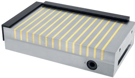
Permanent Magnetspannplatten Typ Neomill, superstarke, kompakte Platten für schwere Zerspanung. Teile ab ca.  $30 \times 15 \times 6$  mm können mit max. erreichbaren Haltekräften aufgespannt werden. Auch an rauen Oberflächen werden noch gute Haltekräfte erzielt. Die Spannplatte wird über einen abnehmbaren Sechskantschalthebel aktiviert.
