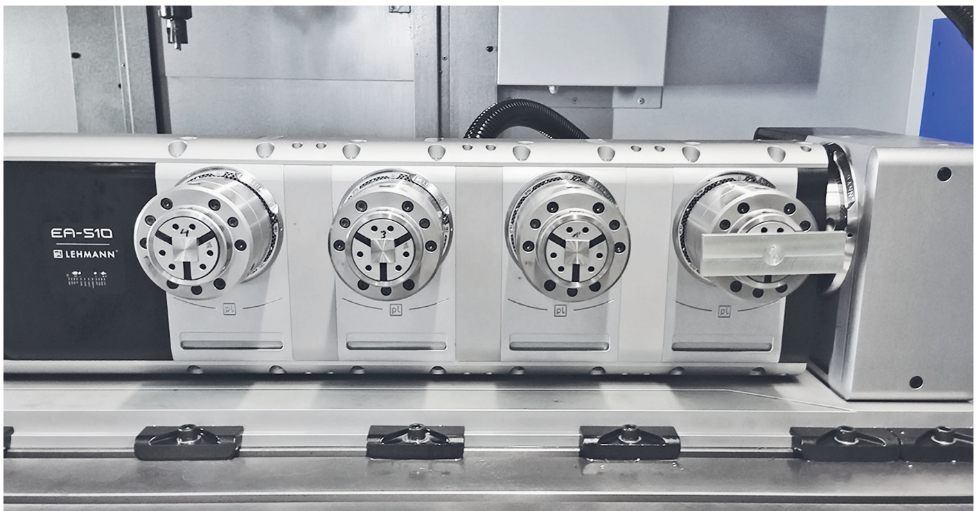
4-Fach Aufspannung für Lehmann Teilapparat
