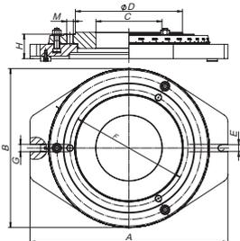
Ausführung: Grundplatte drehbar für Planspiralfutter.
