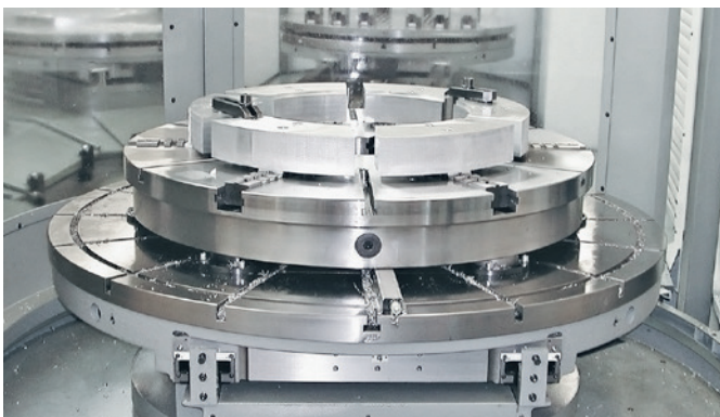
6-Backenfutter \varnothing 1400 mm mit 0-Punkt Spannsystem
