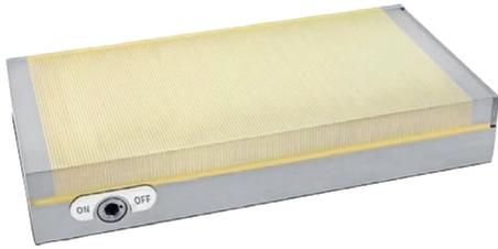
Permanent Magnetspanplatten Typ Neomicro2, hochgenaue Platten zum Spannen von kleinen und dünnen Teilen für Präzisionsschleifarbeiten und zum Erodieren. Die geringe Magnetfeldhöhe verhindert eine Magnetisierung der Bearbeitungswerkzeuge. Die Spannplatte wird über einen abnehmbaren Sechskantschalthebel aktiviert.
