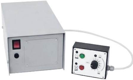
Umpolsteuergeräte: Elektro- und Elektro-Permanent Magnetspanplatten werden an Umpolsteuergeräten betrieben. Diese Geräte ermöglichen es die Haftkraft zu regulieren und Werkstücke zu entmagnetisieren. Umpolsteuergeräte können als Schaltschrankeinbau- oder Tischgerät geliefert werden. Es ist auf die Spannung und die Leistung des Magneten zu achten. Elektro- und Elektro-Permanentsysteme sind untereinander nicht kompatibel. Zur Auswahl des richtigen Gerätes beraten wir Sie gerne.
