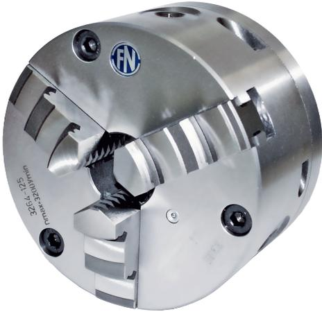
Mit radialer Feineinstellung nach DIN 6350 zentrisch spannendes Hochpräzisionsfutter aus Guss. Mit drei Feineinstellschrauben radial für eine Einstellgenauigkeit innerhalb 0.005 mm, Wiederholgenauigkeit 0.015 mm. Die Einstellspindeln sind gehärtet sowie die Abstützflächen induktiv gehärtet.
