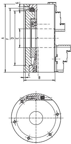
Mit zylindrischer Zentrieraufnahme DIN 6350
