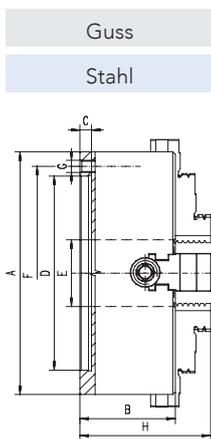
Mit zylindrischer Zentrieraufnahme DIN 6350
