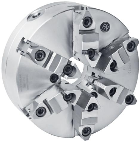
Die Spannbacken werden mit Hilfe von Kegelrädern (Ritzeln) und der Planspirale im Spannbereich zentrisch und stufenlos geöffnet oder geschlossen. Futterkörper aus Guss/Stahl mit Zentralschmierung. Planspirale und Spannbacken sind im Einsatz gehärtet. Flanken der Spirale und Gewindeflanken der Spannbacken beidseitig geschliffen.
