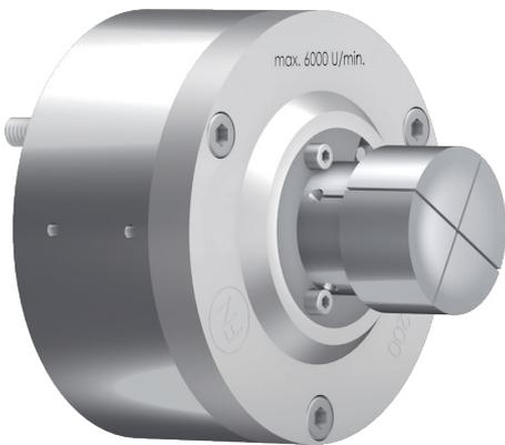
Spannzangenfutter druckluftbetätigt für Ottet-Spannzangen für Innen- und Aussenspannung. Das Spannzangenfutter hat einen innenliegenden Spannkolben, der mit Druckluft beaufschlagt werden kann. Dies ermöglicht den Anbau an Maschinen mit oder ohne Zugzylinder, es wird lediglich eine Drehdurchführung benötigt um die Luft in die rotierende Spindel zu übertragen. Das Futter eignet sich für Aussen- und Innenspannung. Keine Spülung durchs Zentrum vorhanden.
