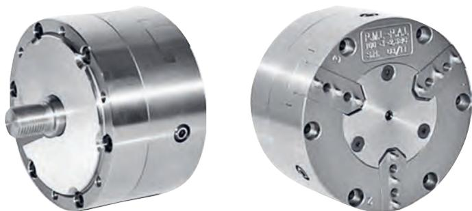
Futterkörper aus Stahl, Grundbacken aus gehärtetem Werkzeugstahl, ohne Kühlmitteldurchlass, mit Aufsatzbacken, mit Zugbolzen für kraftbetätigten Einsatz mit Zylinder.
