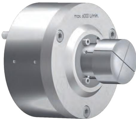
Spannanzenfutter druckluftbetätigt für Ottet-Spannzangen für Innen- und Aussenspannung. Das Spannanzenfutter hat einen innenliegenden Spannkolben, der mit Druckluft beaufschlagt werden kann. Dies ermöglicht den Anbau an Maschinen mit oder ohne Zugsylinder, es wird lediglich eine Drehdurchführung benötigt um die Luft in die rotierende Spindel zu übertragen. Das Futter eignet sich für Aussen- und Innenspannung. Keine Spülung durchs Zentrum vorhanden.
