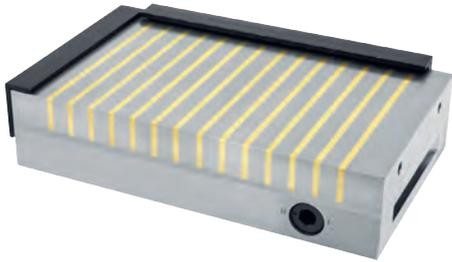
Permanent Magnetspanplatten Typ Neomill, superstarke, kompakte Platten für schwere Zerspanung. Teile ab ca.  $30 \times 15 \times 6$  mm können mit max. erreichbaren Haltekräften aufgespannt werden. Auch an rauen Oberflächen werden noch gute Haltekräfte erzielt. Die Spannplatte wird über einen abnehmbaren Sechskantschalthebel aktiviert.
