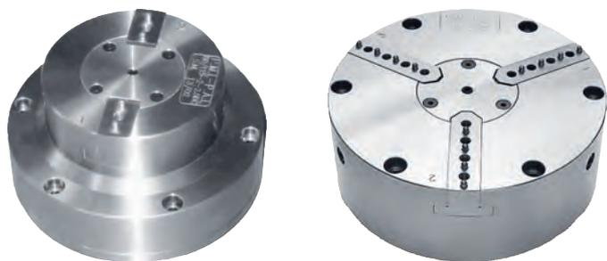
Mit integriertem, pneum. Spannzylinder, Futterkörper aus Stahl, Grundbacken aus gehärtetem Werkzeugstahl, mit / ohne Kühlmitteldurchlass, mit Aufsatzbacken.
