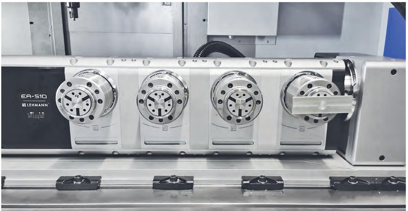
4-Fach Aufspannung für Lehmann Teilapparat
