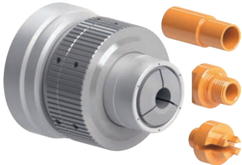
Spannzangenfutter Typ FNP-KAH-B45 mit Hubbegrenzung für den Einsatz von Standard Zugspannzangen, Version Axfix
