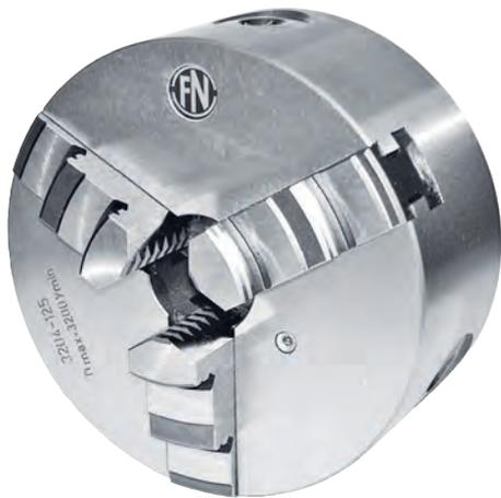
Die Spannbacken werden mit Hilfe von Kegelrädern (Ritzeln) und der Planspirale im Spannbereich zentrisch und stufenlos geöffnet oder geschlossen. Futterkörper aus Guss oder Stahl mit Zentralschmierung. Planspirale und Spannbacken sind im Einsatz gehärtet. Flanken der Spirale und Gewindeflanken der Spannbacken beidseitig geschliffen.
