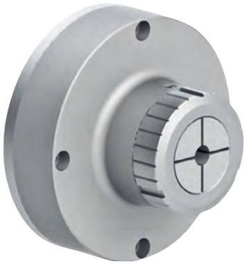
Der Spannstock eignet sich hervorragend für Arbeiten, die keine Teiloperation erfordern. Der doppelt wirkende, pneumatische Spannstock ist nur für den vertikalen Einsatz gedacht. Dank einer formschlüssigen Spannung durch Druckspannzangen werden die Teile nicht deformiert und sicher gespannt.
