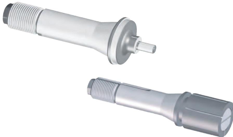
Die Spreizdorne dienen dazu, Stücke von innen zu spannen. Sie unterscheiden sich von den Ringfuttern durch ihre Konstruktion, die einen besseren Rundlauf garantiert sowie eine Spannung von längeren Werkstücken und kleineren Durchmessern erlaubt. Die Spreizdorne führen wir nur in den geläufigsten Typen für SCHAUBLIN-Maschinen oder solche, welche die Verwendung dieser Ausführung gestatten. Es gibt zwei grundsätzlich verschiedene Ausführungen von Spreizdornen:
