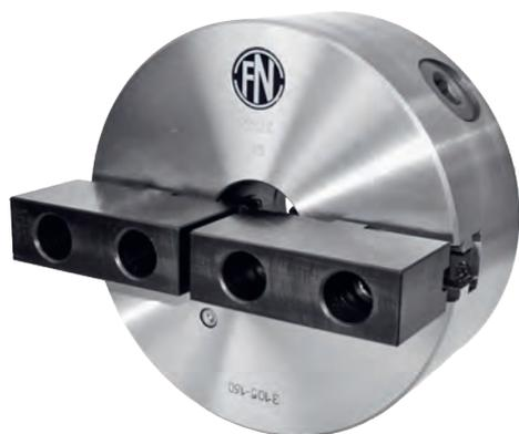
Die Spannbacken werden mit Hilfe von Kegelrädern (Ritzeln) und der Planspirale im Spannbereich zentrisch und stufenlos geöffnet oder geschlossen. Futterkörper aus Guss mit Zentralschmierung. Planspirale und Spannbacken sind im Einsatz gehärtet. Flanken der Spirale und Gewindeflanken der Spannbacken beidseitig geschliffen.
