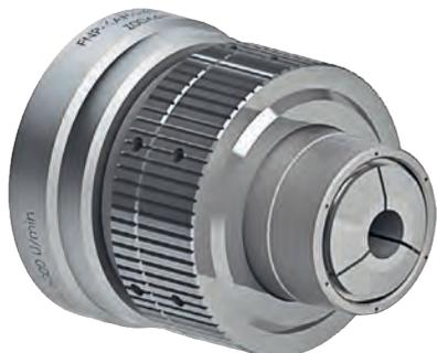
Durch die mechanische Hubeinstellung kann die Spannkraft begrenzt werden, dadurch können sehr dünnwandige Werkstücke bis zu einer Wandstärke von 0.25mm deformationsfrei gespannt werden. Die mechanische Hubeinstellung ist von aussen her zugänglich und kann direkt auf der Maschine eingestellt werden.
