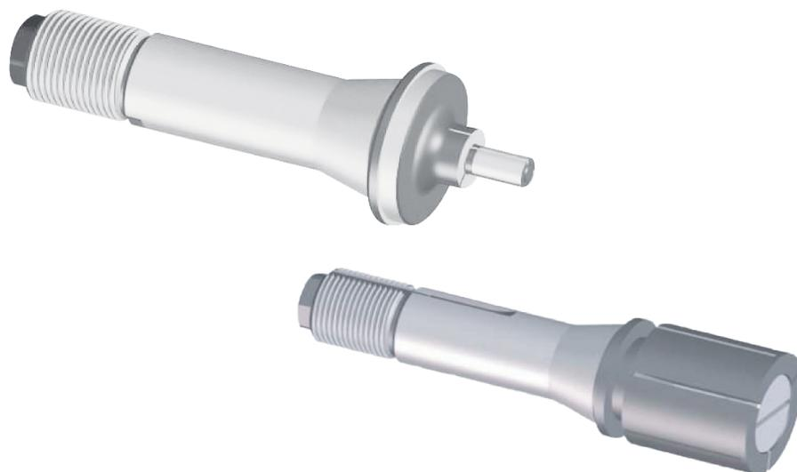
Die Spreizdorne dienen dazu, Stücke von innen zu spannen. Sie unterscheiden sich von den Ringfuttern durch ihre Konstruktion, die einen besseren Rundlauf garantiert sowie eine Spannung von längeren Werkstücken und kleineren Durchmessern erlaubt. Die Spreizdorne führen wir nur in den geläufigsten Typen für SCHAUBLIN-Maschinen oder solche, welche die Verwendung dieser Ausführung gestatten. Es gibt zwei grundsätzlich verschiedene Ausführungen von Spreizdornen:
