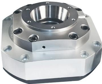
Stationäres Spannfutter pneumatisch für Spannköpfe System Hainbuch Gr. 42 und 65. Die Luftzuführung kann wahlweise über seitliche Verschraubungen oder O-Ringe im Unterteil gewählt werden. Das Futter hat eine Absicherung durch innenliegende Spannfedern, diese unterstützen die Spannkraft und bei Luftabfall bleibt die Spannung erhalten. Körper aus Aluminium, Verschleissteile aus Stahl gehärtet und geschliffen.
